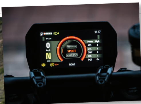
La pantalla TFT de cinco pulgadas permite personalización, conectividad y navegación opcional mediante el sistema multimedia Ducati.
