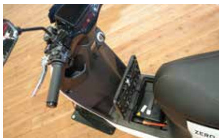
El nuevo eléctrico equipa dos baterías intercambiables situadas en el suelo que mejoran el equilibrio y permiten ampliar la autonomía.
