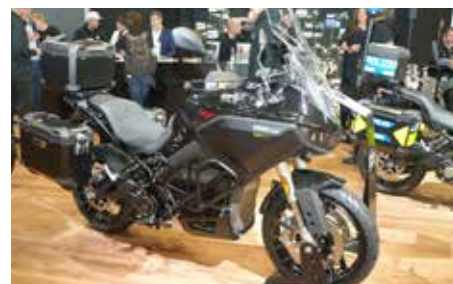
La DSR/X incorpora ayudas electrónicas optimizadas, mientras la versión Black Forest añade de serie un cargador rápido de seis kilovatios.
